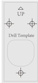
Plantilla de perforación para el panel del interfono (x1)
